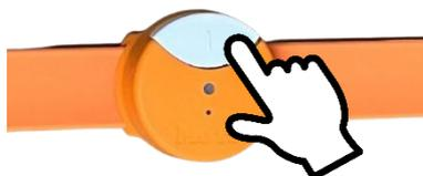
3. 電源が入っている状態で、ボタンを 3 秒長押しすると、赤色 LED が点灯します。離すと電源が OFF 状態になります。
